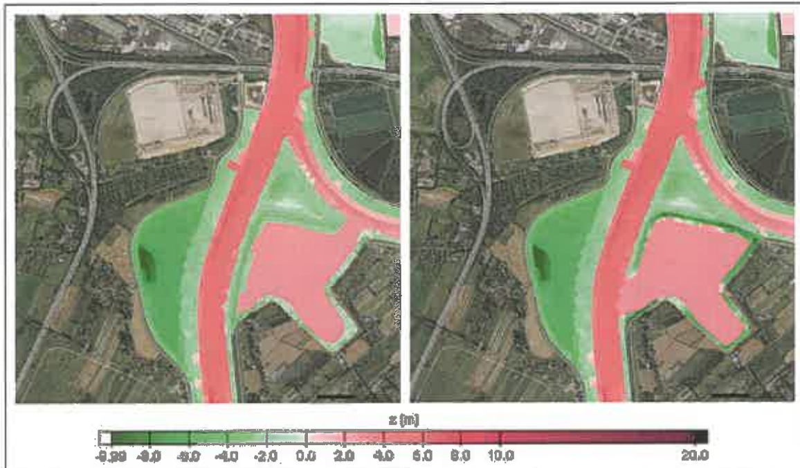
Bild 4.3 Ausschnitt der Modelltopographie der Ausbauzustände (AZ) der Maßnahme Spadenländer Ausschlag mit dem Anschluss nach Osten (links) bzw. Westen (rechts).
