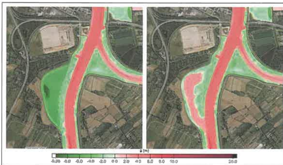
Bild 4.2 Ausschnitt der Modelltopographie des planerischen Ist-Zustands PIZ (links) und des Ausbauzustands AZ (rechts) der Maßnahme Kreettsand (Variante 1).
