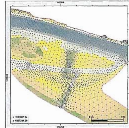
Bild 36: Ansicht des Modellgitters mit schematischer Modelltopographie in der Variante 7
