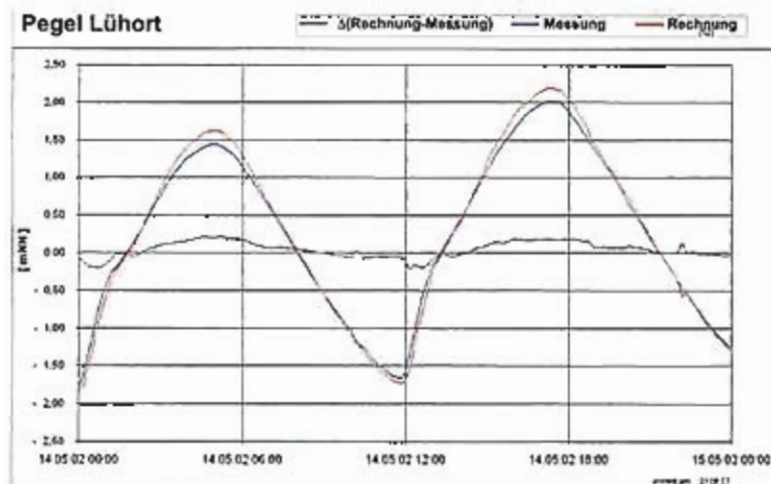
Bild 7: Vergleich der gemessenen mit den aus dem Modell berechneten Wasserständen am Pegel Lühort – ein Tag
